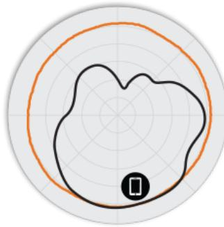
Figura 4. Pattern di antenna Elevazione a 2,4 GHz per H320
