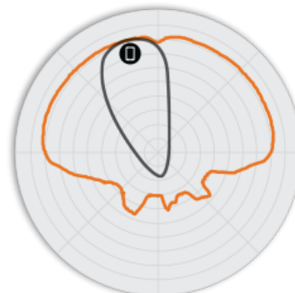
Figure 4. H320 2,4 GHz: patrones de antena en elevación
