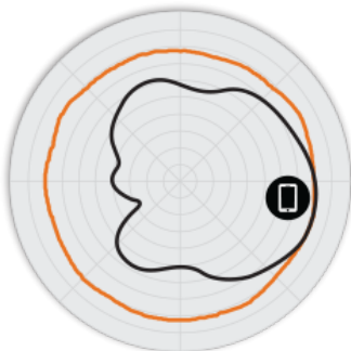
Figure 2. H320 2,4 GHz: patrones de antena en acimut
