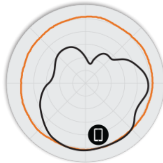
Figure 3. H320 5 GHz: patrones de antena en acimut
