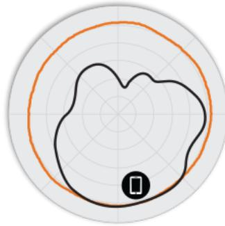
Abbildung 4. H320 2,4 GHz-Elevation-Antennenmuster
