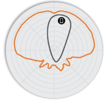
Hinweis: Die äußere Linie stellt die zusammengesetzte HF-Abdeckung aller möglichen BeamFlex+-Antennenmuster dar, während die innere Linie ein BeamFlex+-Antennenmuster innerhalb der gesamten Außenlinie abbildet.
