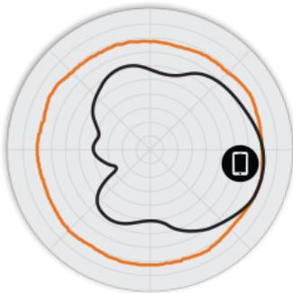
Abbildung 3. H320 5 GHz-Azimet-Antennenmuster
