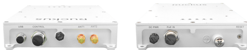
Vista frontal e traseira do módulo de RF do AP E510
