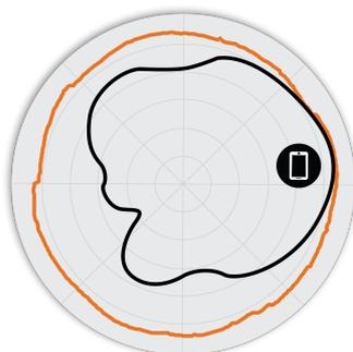
図 4 E510 2.4GHz エレベーション アンテナパターン
