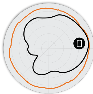
Figura 3. Pattern di antenna Azimut a 5 GHz per E510
