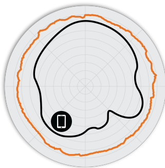
Figura 2. Pattern di antenna Azimut a 2,4 GHz per E510
