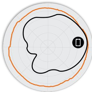
Abbildung 4. E510 2,4 GHz-Elevation-Antennenmuster
