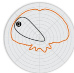
Примечание. Внешний контур представляет собой составную РЧ-зону всех возможных диаграмм направленности антенны BeamFlex+, а внутренний контур — одну диаграмму направленности антенны BeamFlex+ в рамках составного внешнего контура.
