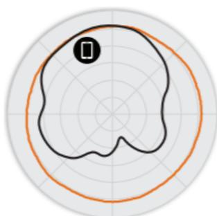
Рисунок 5. Вертикальная плоскость 5 ГГц C110 Диаграммы направленности антенны
