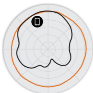
Рисунок 4. Вертикальная плоскость 2,4 ГГц C110 Диаграммы направленности антенны
