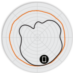
Figura 2. Padrões de antena do azimute C110 2,4 GHz
