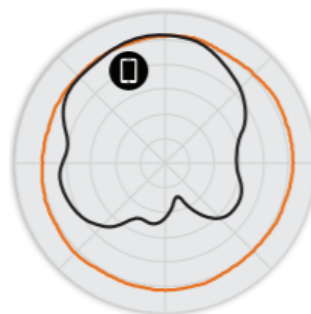
Figura 4. Padrões de antena de elevação C110 2,4 GHz
