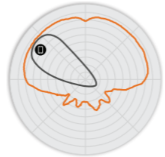
FIGURE 5 Diagrammes d'antennes Élévation C110 5 GHz
