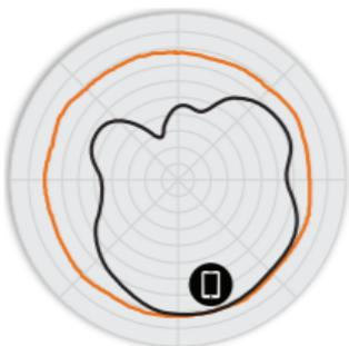
Figure 3. Diagrammes d'antennes Azimut C110 5 GHz
