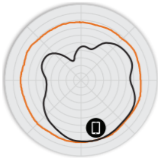
FIGURE 2 Diagrammes d'antennes Azimut C110 2,4 GHz
