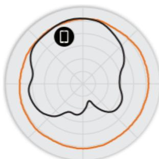
Figure 5. Diagrammes d'antennes Élévation C110 5 GHz
