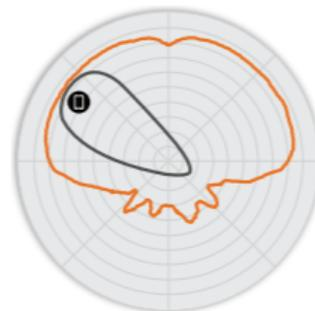
Remarque : le tracé extérieur représente l'empreinte RF composite de chaque diagramme de rayonnement BeamFlex+ possible, tandis que le tracé intérieur représente un diagramme de rayonnement au sein du tracé extérieur composite.
