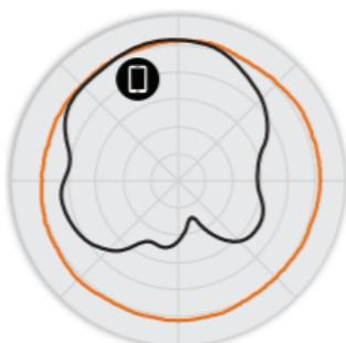
Figure 4. Diagrammes d'antennes Élévation C110 2,4 GHz
