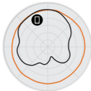
FIGURE 4 Diagrammes d'antennes Élévation C110 2,4 GHz
