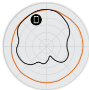
FIGURE 3 Diagrammes d'antennes Azimut C110 5 GHz
