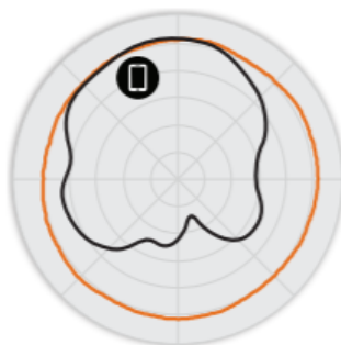
Figure 3. C110 5 GHz: patrones de antena en acimut
