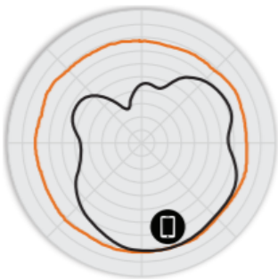
Figure 2. C110 2,4 GHz: patrones de antena en acimut
